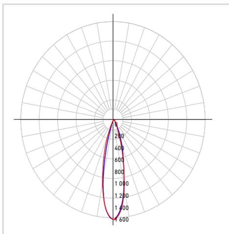
\*Puissance lumineuse mesurée à 3000K
